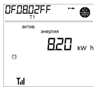
Рисунок 4.4 – Меню 1 Кадр 2. Энергия активная (импорт + экспорт) нарастающим итогом по тарифу 2 (ночь), в кВт·ч
